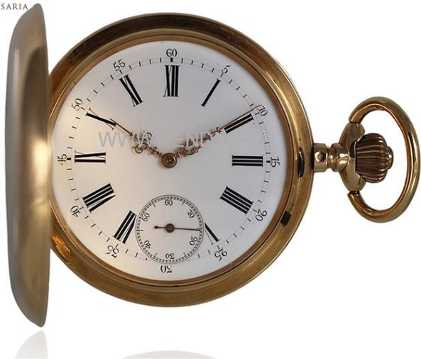
\* Relógio de bolso com movimento FHF 21,0 "" mecânico de corda manual com uma frequência de 18,000 alternâncias/horas e com uma reserva de corda aproximada de 30 horas fabricado a partir de 1905.
